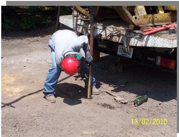
Realizando el ensayo S.P.T.
